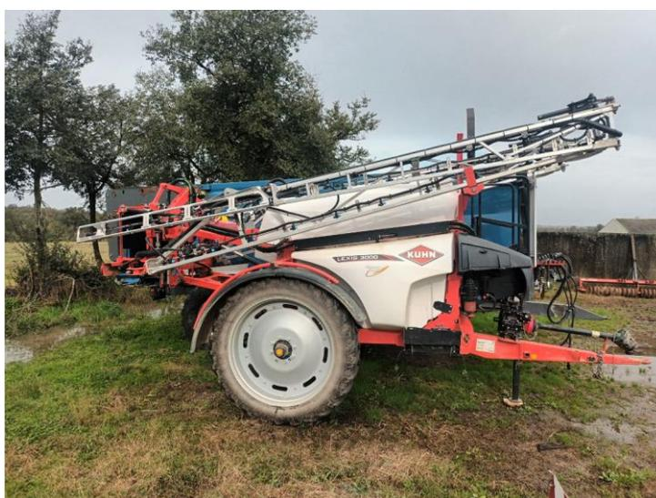
Ce dispositif permet de gérer automatiquement la coupure des tronçons basés sur le GPS. Ce système permet d'ouvrir et de fermer chaque tronçon du pulvérisateur. Avec ce système, nous gagnons en précision et aussi en confort de conduite à ne pas négliger, surtout avec les plages de traitement qui sont souvent réduites avec la météo.
